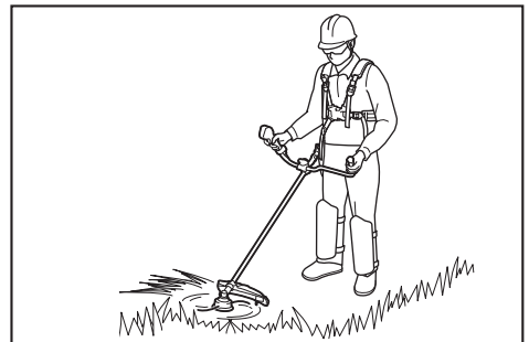
► 1. La posición del colgador con respecto al suelo 2. La posición de la herramienta de corte con respecto al suelo 3. La distancia horizontal entre el colgador y la parte sin protección de la herramienta de corte
